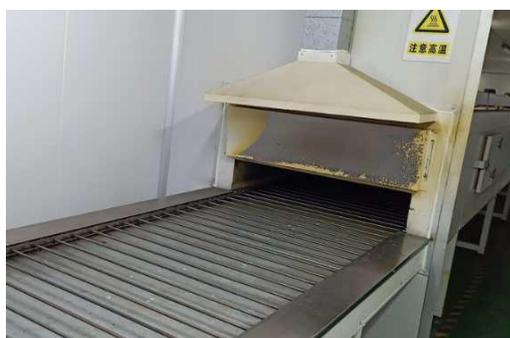
(d) A~C#喷漆线固化电烤箱
