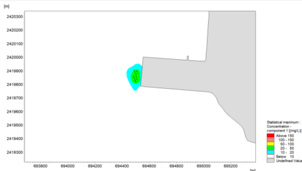
图 4.1.3-4 打桩工况下施工作业悬浮物增量浓度包络图
