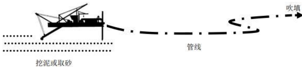
图 2.6.3-3 绞吸式挖泥船作业示意图
