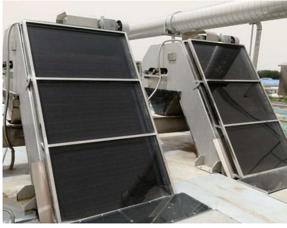
图 4-2 格栅密闭收集实例
