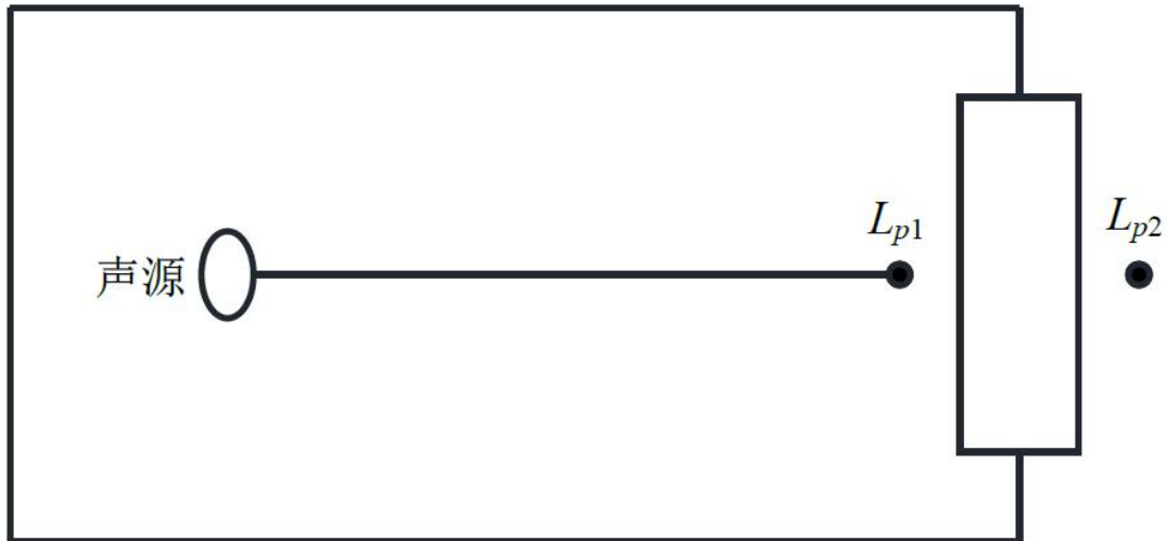
图 4.1 室内声源等效为室外声源图例
