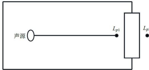
图 4-2 室内声源等效为室外声源图例
