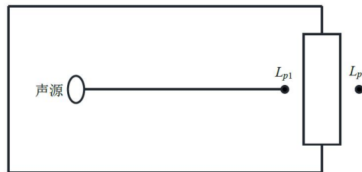
图 4-2 室内声源等效为室外声源图例
