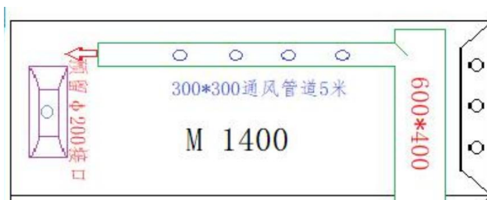
图 4-1 每台生产设备废气收集口示意图
