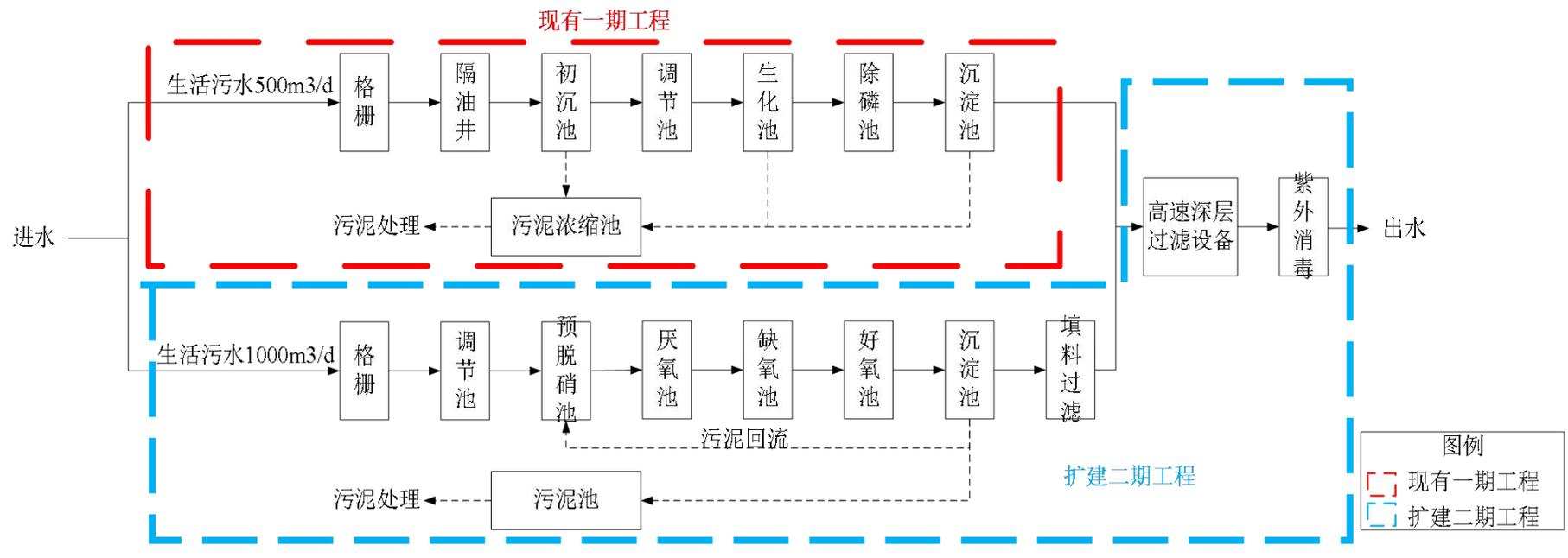
图 2-10 扩建后全厂废水处理工艺流程图
