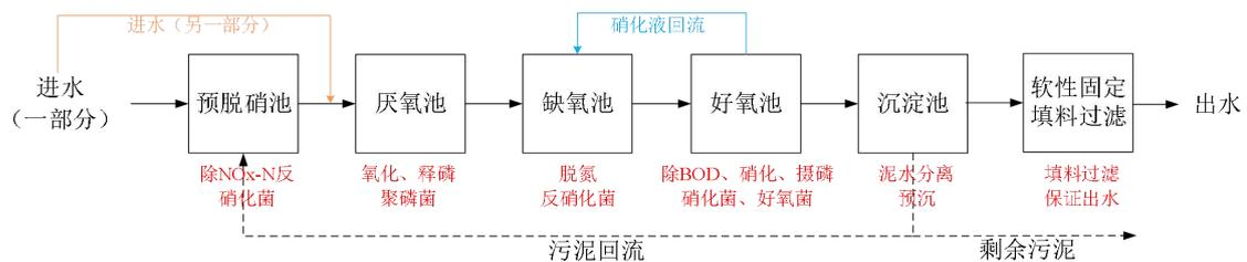
图 2-6 “A<sup>3</sup>/O-平板膜填料”工艺技术原理图
