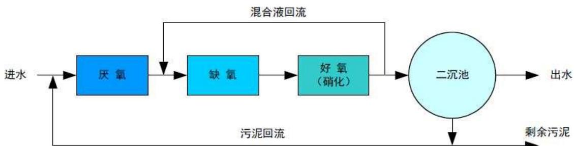
图 2-4 常规 AAO 工艺流程图
