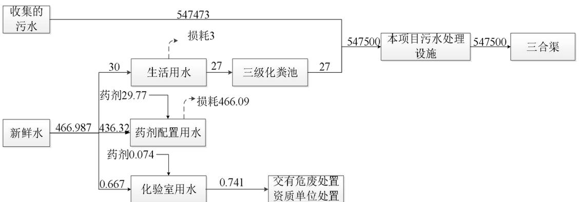
图 2-3 扩建后全厂项目水平衡图 (单位: m³/a)
