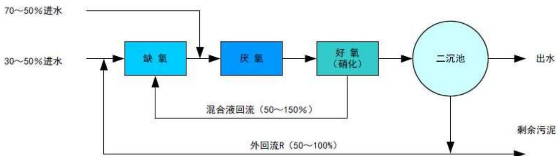
图 2-5 倒置 AAO 工艺流程图
