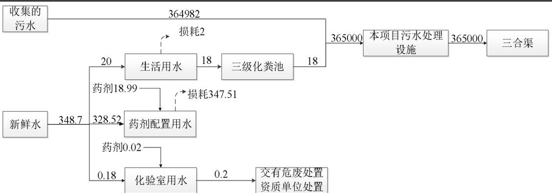
图 2-2 本项目扩建部分水平衡图 (单位: m³/a)
