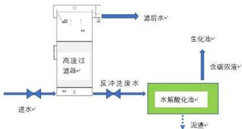
图 2-9 高速深层过滤装置过滤及碳源回收技术流程图
