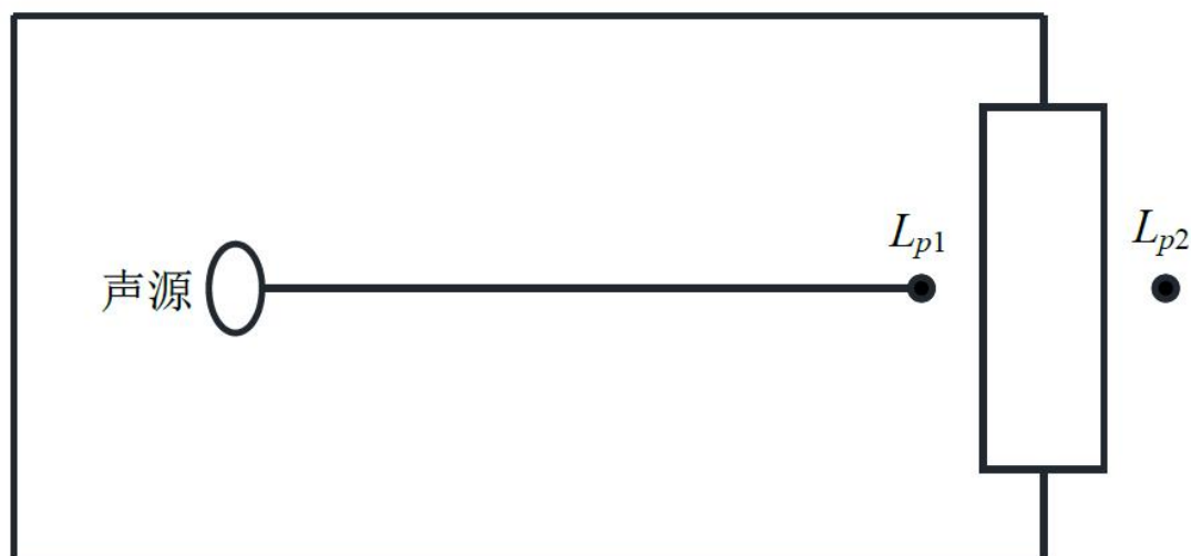
图 4.1 室内声源等效为室外声源图例
