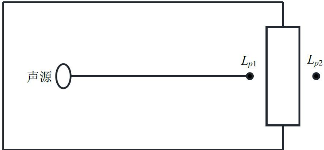
图 4.1 室内声源等效为室外声源图例
