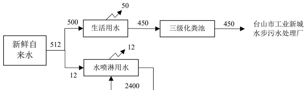
图 2-1 项目水平衡图 (单位: t/a)
