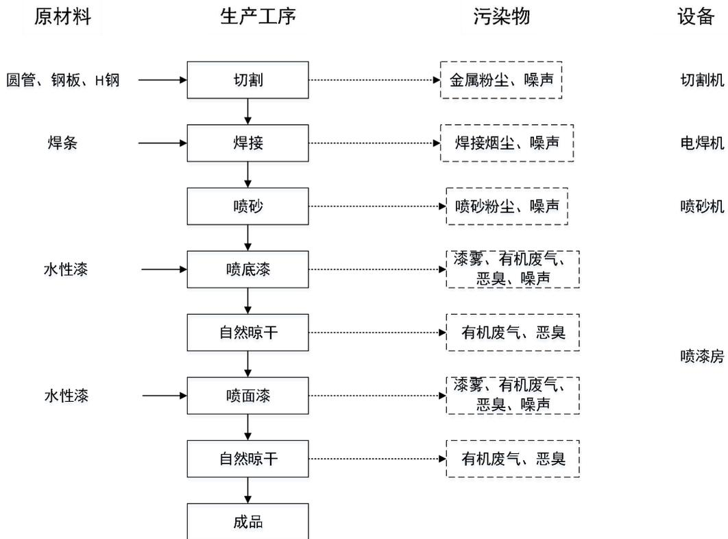
图 4 钢梁、钢柱工艺流程图及产污环节图
