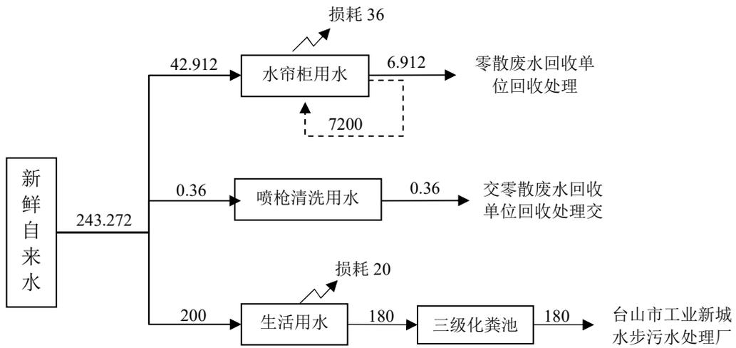
图 2-1 项目水平衡图 (单位: t/a)
