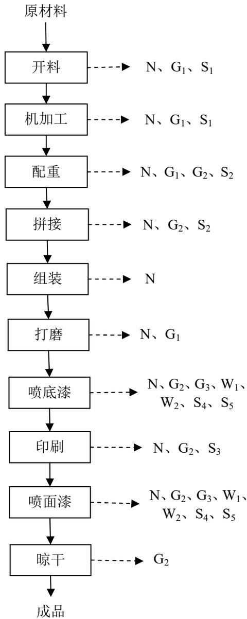
图2-2 项目生产工艺流程图
