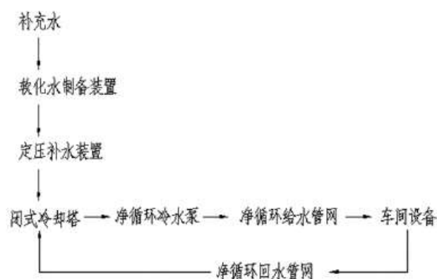
图 8.2-6 挤压车间净循环水系统工艺流程
