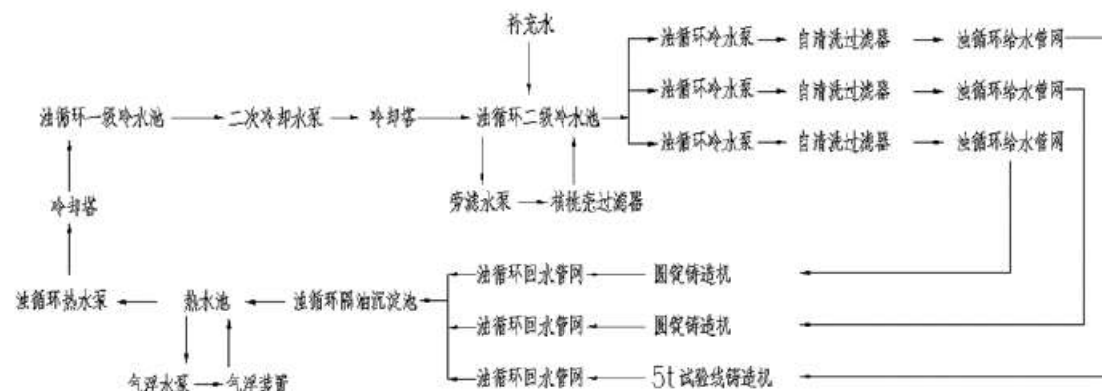
图 8.2-1 合金车间 1#油循环水系统工艺流程
