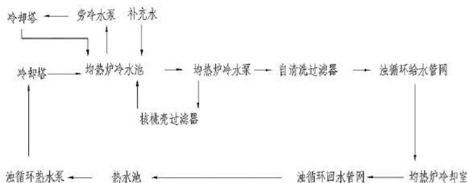
图 8.2-3 合金车间 3#油循环水系统工艺流程
