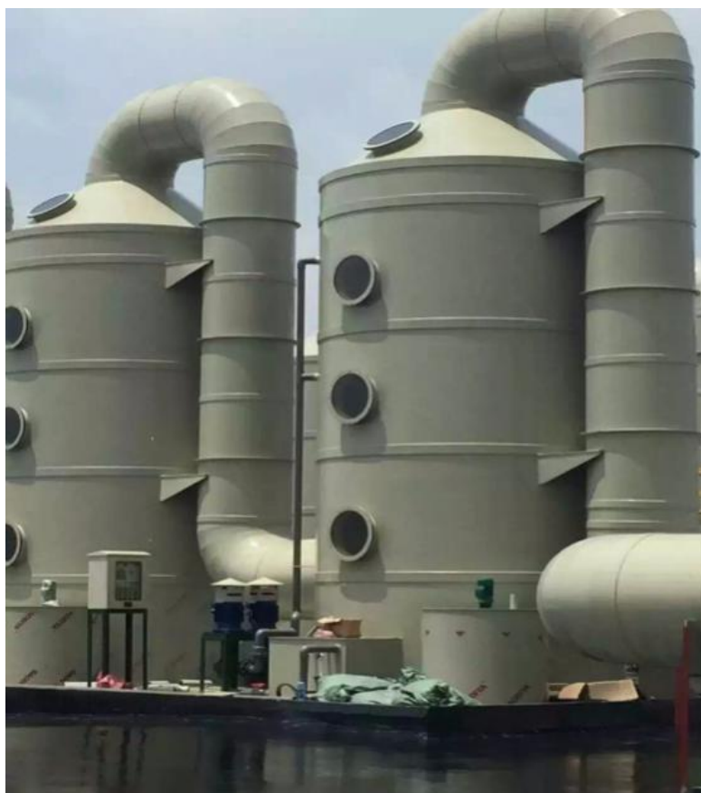
图 6.3-2 生物除臭塔装置图
