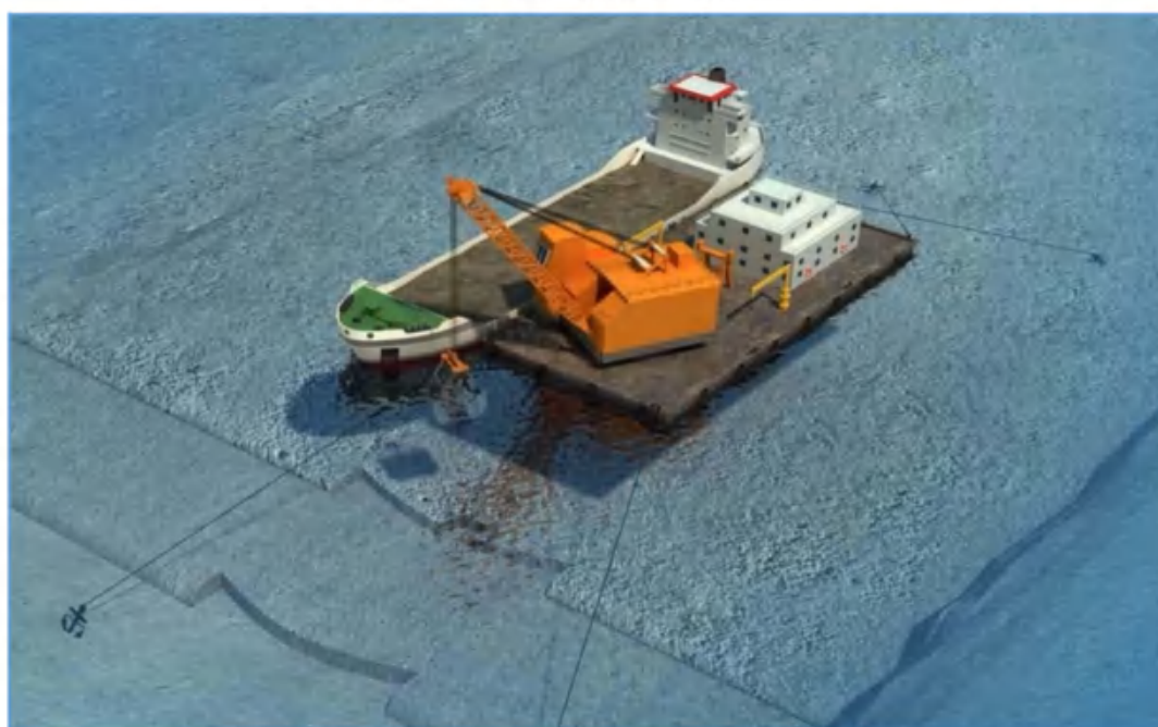
图 2.3.1-2 锚缆定位抓斗船施工示意图
