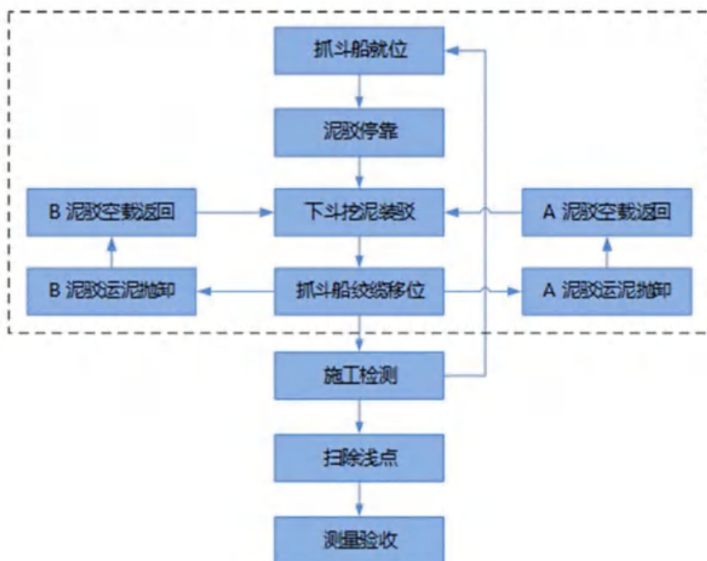
图 2.3.1-1 抓斗船施工流程图
