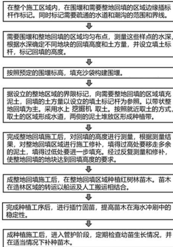
图 2.6.2-1 红树林造林施工工艺流程图
