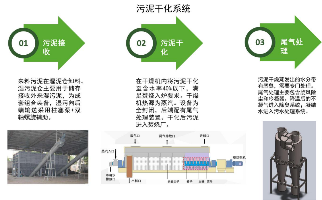
图 9-6 污泥干化工艺流程
