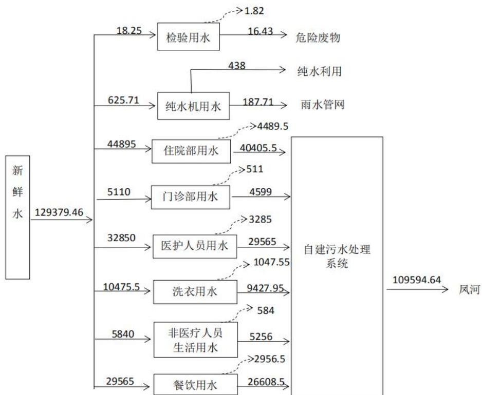
图 2-1 水平衡图 (单位: m³/a)
